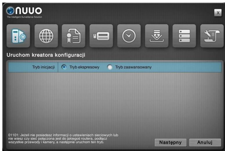
**Tryb Ekspresowy:** nie jest wymagana konfiguracja sieci oraz RAID.
